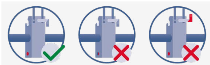
Abb. 43: Positivt och negativt exempel: slutstycket helt utdraget och låsstiftet i ingrepp
