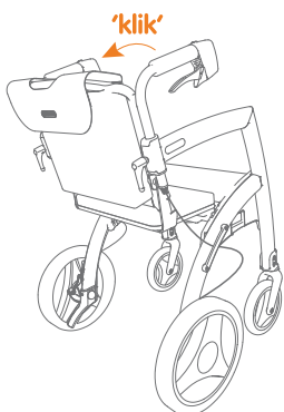
Figur 35: : Klik ryglænet ind i styreskinnerne.
